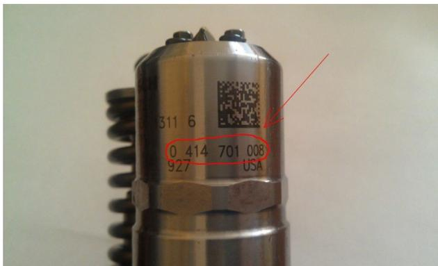
Рисунок 3.1 – Номер форсунки Bosch на электромагните
