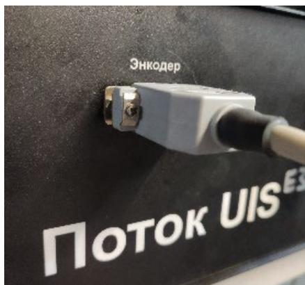
Рисунок 2.2 – Подключение кабеля энкодера
