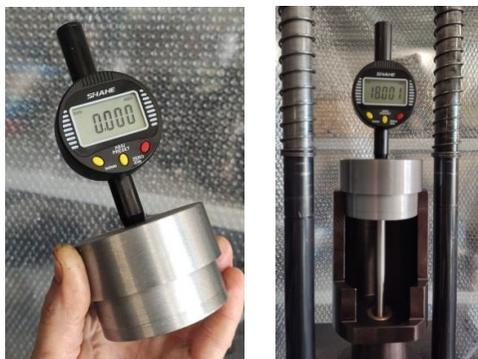
Рисунок 2.11 – Установка индикаторной головки в камбокс
