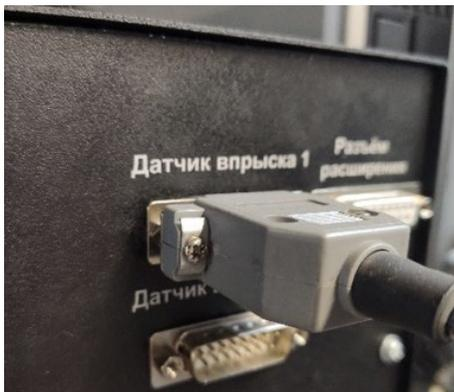
Рисунок 2.4 – Подключение кабеля датчика Load-Cell
